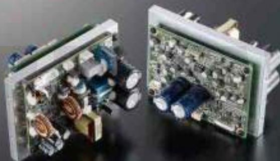
構與我曾經評測過的TEAC NT-503相當近似，差別在於NT-503每聲道有兩組放大電路（可作平衡輸出）、NR-7CD則是一組，雖然本機的耳擴是單端輸出，但是左右聲道的接地回路並不是「共用」而是「各自獨立」、配置3.5mm 4極耳機端子，若您使用的耳機配備這樣的耳機線（也就是接上3.5mm 4極平衡耳機線），NR-7CD耳擴電路左右獨立接地的設計可讓您聽到如同平衡驅動低串音、高分離度的效果。
