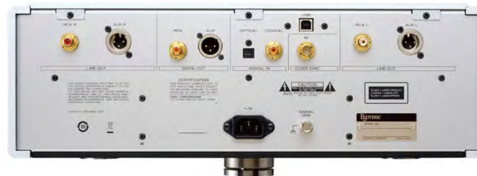
上圖：K-01X 最明顯的辨識方式就是承盤前方那一條的亮面金屬。 下圖：在背面的端子配置上與前一代的 K-01 已大為不同，K-01X 將類比輸出都放到左邊，USB 數位輸入移到了 CLOCK IN 的上方，這樣的改變應是配合線路的重新設計所調整。
